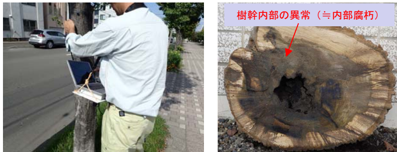
写真-2 樹木診断装置を用いた診断（左）と樹幹内部の異常（右）
