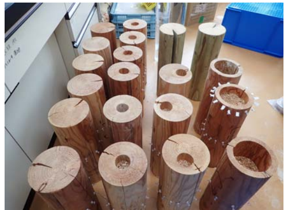
写真-1 異常部位を加工した丸太
