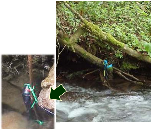
写真-1 水位計の設置状況
