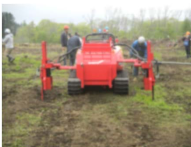
写真-1 コンテナ苗植栽試験に使用した土壤穿孔機（試作機）
