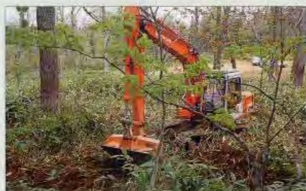
写真-1 バックホウによる樹冠下でのかき起し
