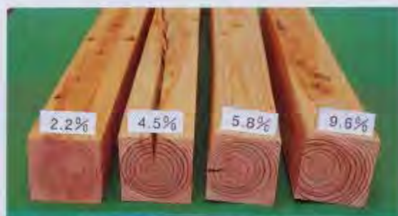
繊維傾斜度と製材のねじれとの関係 繊維傾斜度は幹の繊維走行の傾きを表し、数値が大きいと乾燥した時の製材のねじれも大きい。繊維傾斜度2.2%の材が「グリーン」。
