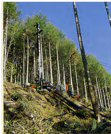
写真 - 2 タワーヤードによる集材作業
