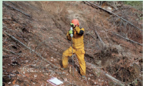
写真-1 土壌貫入試験による土の硬さの調査
