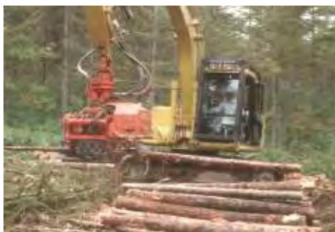
プロセッサによるカラマツの枝払い・玉切り
