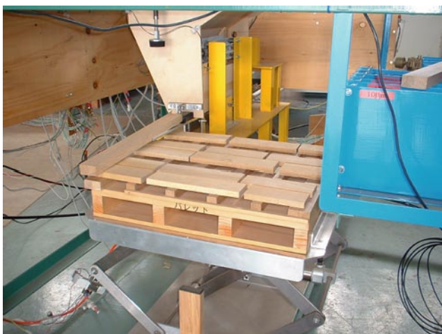
写真4 栈木の一端が接地
