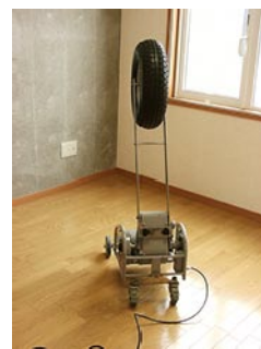
住宅の床衝撃音測定
