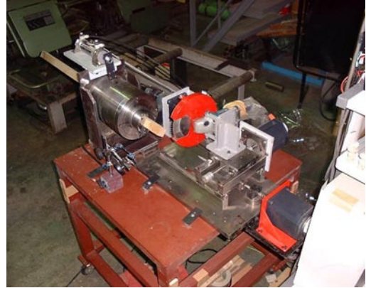
写真1 パソコンを用いた簡易型木工用NC旋盤
