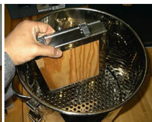
スモールチャンバーによる建築材料の精密測定
