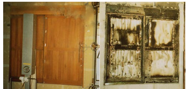
写真 引き戸の耐火試験 左：加熱中、右：加熱終了後の加熱面
