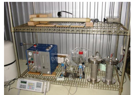
写真3 光触媒効果の測定装置
