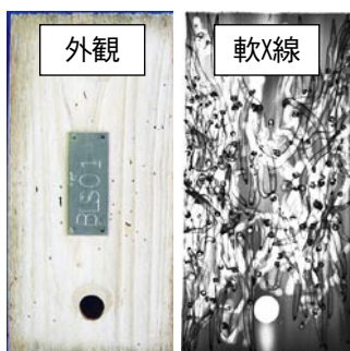
写真2 海虫による被害
