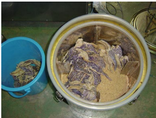
写真2 発酵槽内のヒトデと木粉（処理前）
