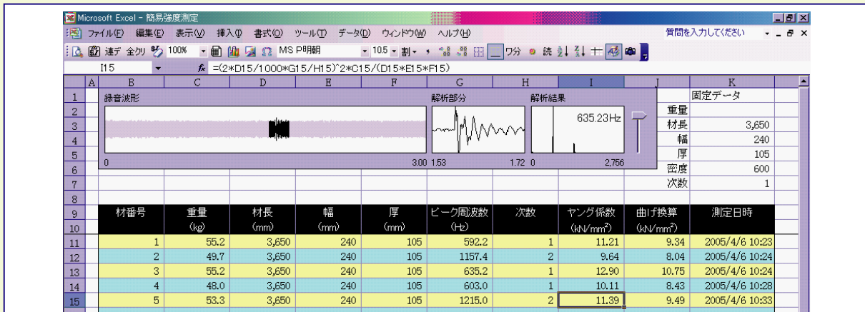
簡易強度測定プログラム（グラフ部分をクリックしてから、木材の木口をかなづちなどで叩く）
