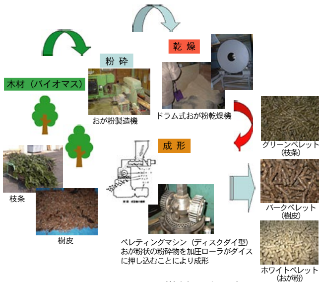
図1 ペレット燃料の造り方
