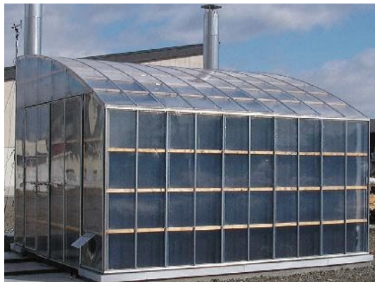
写真1 太陽熱木材乾燥装置（林産試験場に設置）
