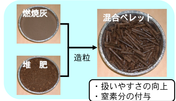
図2 燃焼灰と堆肥の混合ペレット化
