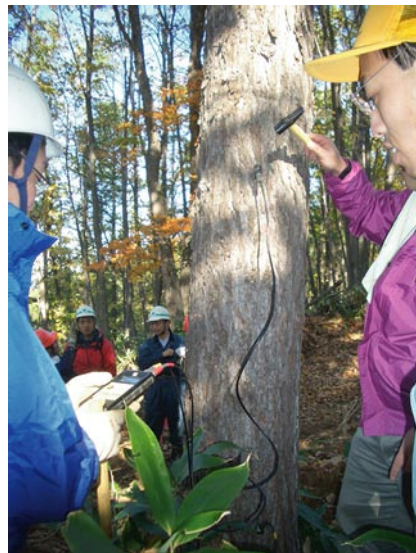
伐採前に木材の強度性能を推定する試み
