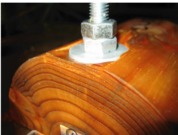
写真1 座金のめり込み試験の様子
