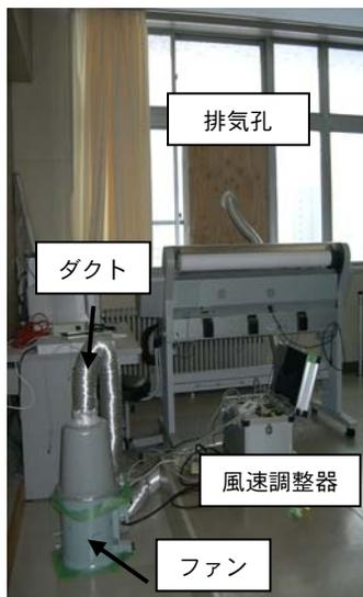
図7 換気装置の外観
