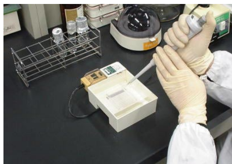
写真3 DNA分析による木材腐朽菌の検出作業 ※PCR法という技術で木材腐朽菌のDNAを探し出す
