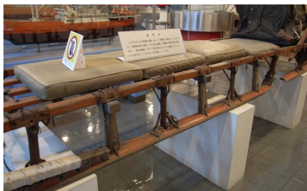
写真4 鉄と木材が使われている束材
