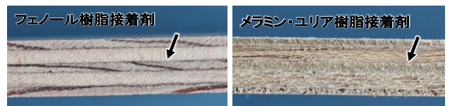
図1 合板接着層の色調（矢印：接着層）
