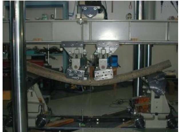
写真2 曲げ強度試験
