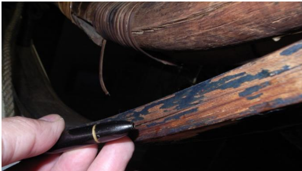
写真3 ラミナを接着して造られたランナー（湾曲部）
