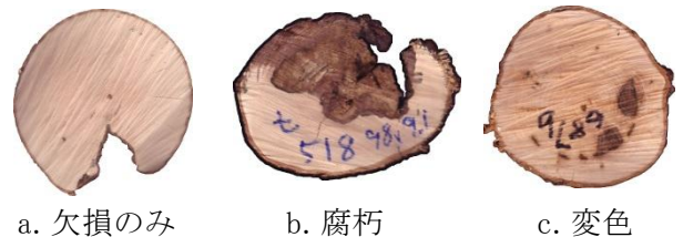
写真3 腐朽等の区分
