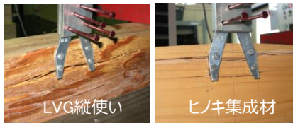
金物接合部の引張試験
