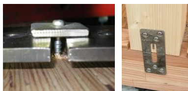
ビス引抜き試験 土台側面にビスで固定する金物
