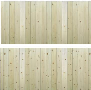
写真1 節のあるトドマツ壁材の例（上：少ないもの、下：多いもの）
