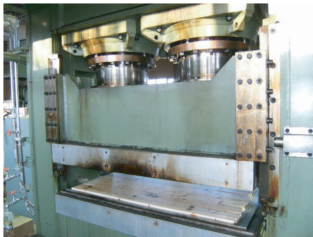
研究課題「道産針葉樹材を用いた圧縮木材生産の事業化支援」より、大型プレス機を用いてトドマツ圧縮木材を製造（平成25年2月25日、林産試験場 粉碎成形試験室）
