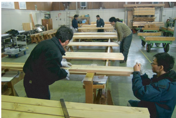
研究課題「道産材を用いた枠組壁工法用製材の性能評価と利用技術の開発」より、カラマツ製材の品質チェック (平成25年1月21日, 林産試験場製材試験室)
