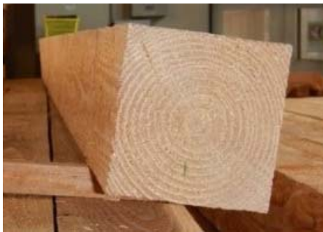
図1 人工乾燥後に大きなねじれが出現したカラマツ材
