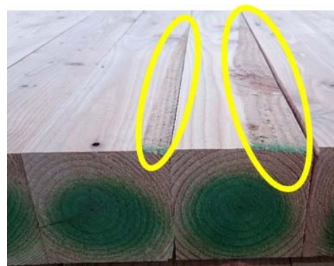
図3 修正加工後に発生した歩切れ(円内:削り残し)
