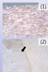
写真6 剥離箇所の接着層の顕微鏡写真 (1)木材、(2)接着剤に破壊の形跡はないことから、十分に接着されていなかったことがわかります。また、木材繊維の跡(矢印)があることから、ラミナは密着したものの接着剤は十分に転写されなかったと推察されます。つまり、圧縮時には接着剤が乾燥・硬化していたために接着不良(乾燥接着不良)が生じたと考えられます。
