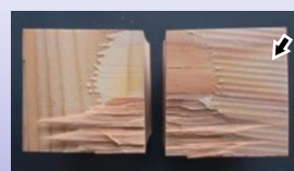
写真5 接着不良箇所の接着層塗布ローラーの跡(矢印)から、接着剤が押し延ばされていないことがわかります。従って、これは、ラミナ同士の密着が不十分で生じた接着不良だと考えられます。
