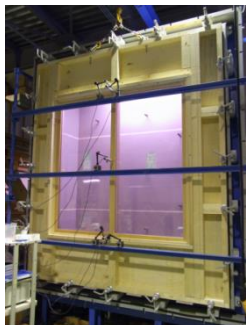
試作サッシの耐風圧試験 (強度試験)
