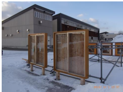
試作サッシの屋外暴露試験
