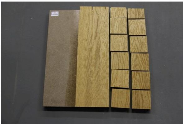
写真1 ミズナラ突き板単板，MDF試験片
