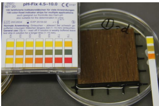
写真10 d (単板+MDF_防かび剤5倍希釈表面塗布) のpH (6.5)
