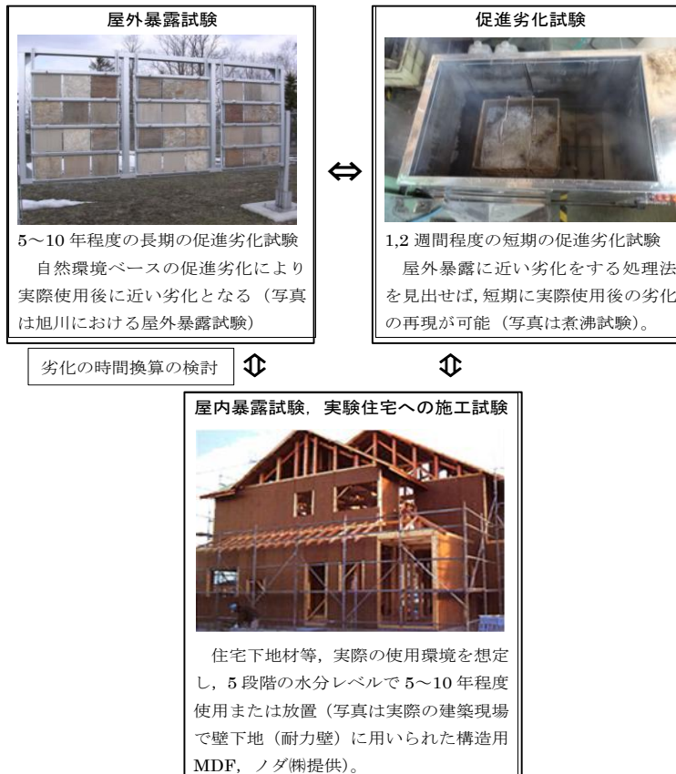
図1 耐久性評価を行う上での屋外暴露試験、促進劣化試験、屋内暴露試験の位置付け
