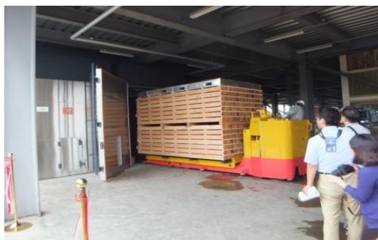
林産試験場が開発した新たな乾燥技術（コアドライ）により生産されるカラマツ建築材
