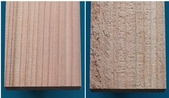
図1 スギ材における、プレーナー仕上げ(左)と粗挽き仕上げ(右)
