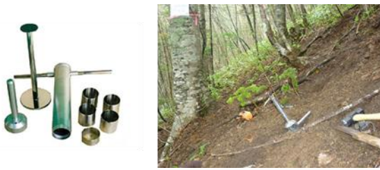
図2 コアサンプラー（左）と 土壌試料採取の様子（右）
