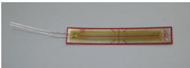
写真2 ひずみゲージ (東京測器社製：PFLW-30-11)
