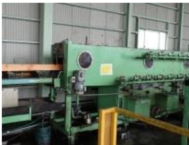
写真3 吹付装置（左）と深浸潤処理されたカラマツ集成材（右）
