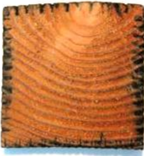
写真2 湿式処理（左、濃緑色が浸透部）と乾式処理カラマツ集成材（右、赤色が浸透部）
