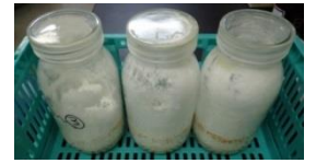
写真3 腐朽菌に暴露した状態
