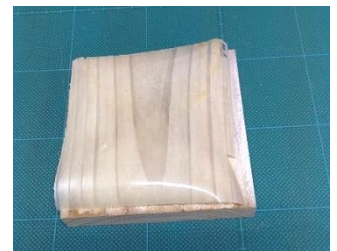
図5 暴露後の塗膜のはく離 (暴露60ヶ月後の水溶性薬剤+塗装)
