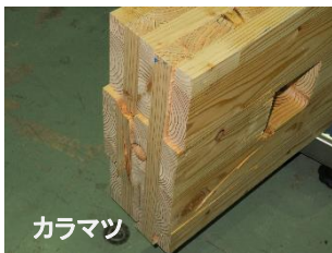
図3 端距離が不足している場合の破壊形態
