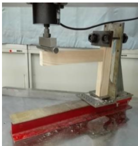
接合部性能試験
