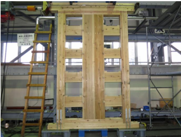
写真2 貫壁の面内せん断試験の様子（加力前）
