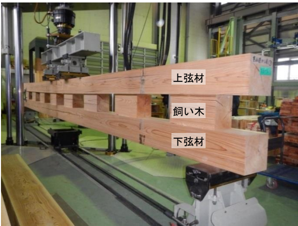
写真5 重ね透かし梁の曲げ試験の様子
