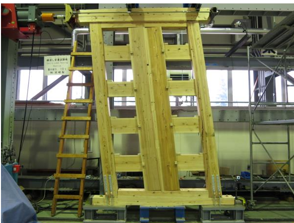
写真3 貫壁の面内せん断試験の様子（1/10rad時）
