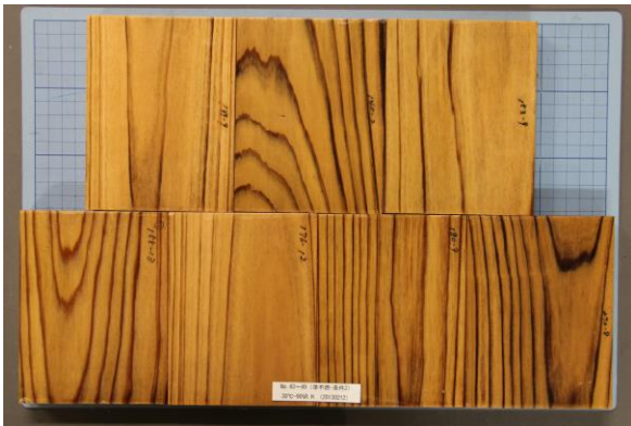
写真4 90%RH終了時の塗装2の表面状態
