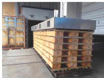
図1 心持ち平角材の乾燥試験
