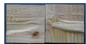
図3 剝離箇所の様子(ねじれ大・堆積時間9分)
