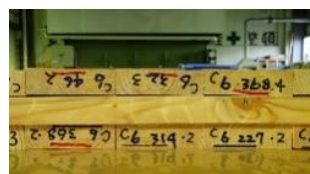
図2 プレス前のラミナのねじれ
