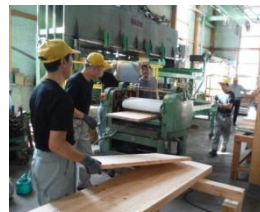
写真1 幅はぎパネルのプレスへの仕組み作業
