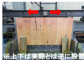
壁パネルと基礎の接合
