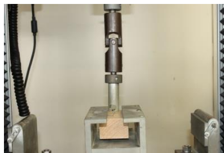
写真2 木ねじ引き抜き試験
