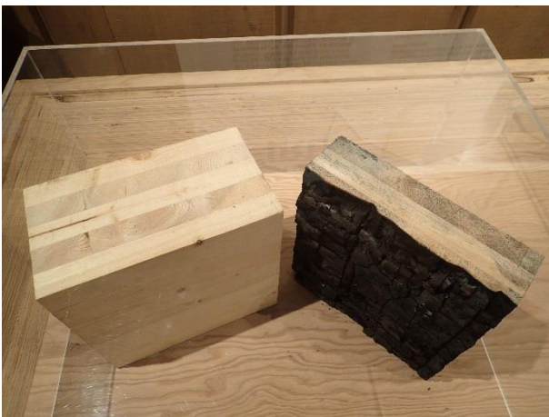
写真2 燃焼試験後のCLT
