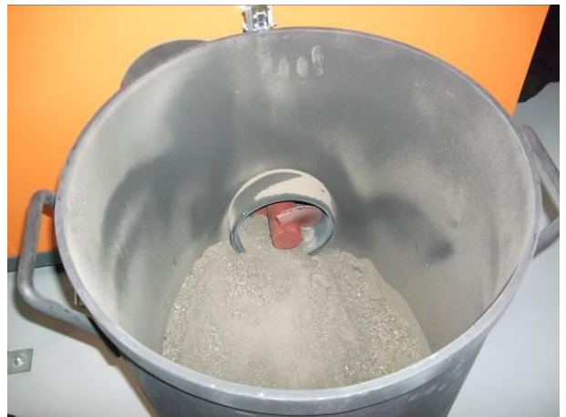
写真1 木質ボイラーから排出される燃焼灰
