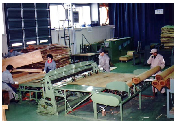
※ 林産試験場大型ロータリーレースによる単板切削の様子
