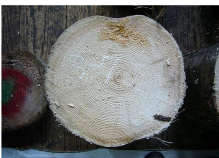
【辺材腐朽の一例】
