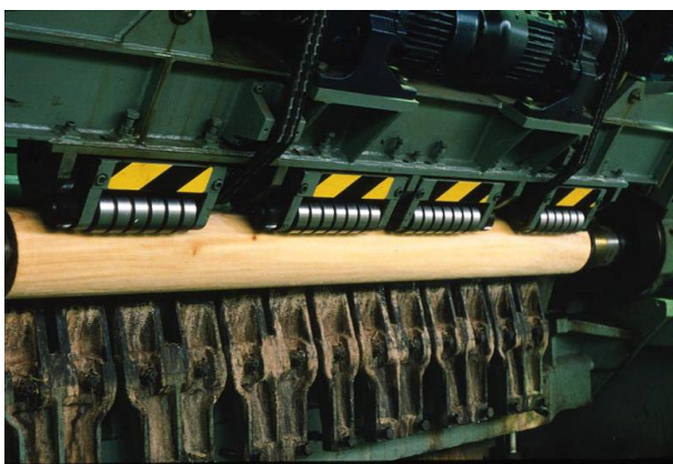
※ 林産試験場大型ロータリーレースによる単板切削の様子
