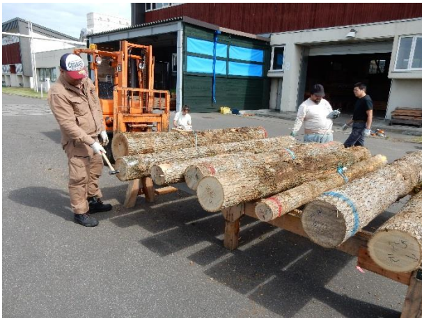
写真4 打撃音法による原木動ヤング係数の測定
