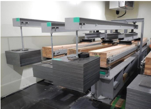
写真2 テコ式荷重装置（側面で変形測定）
