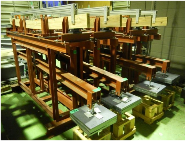
写真1 テコ式荷重装置（上面で変形測定）
