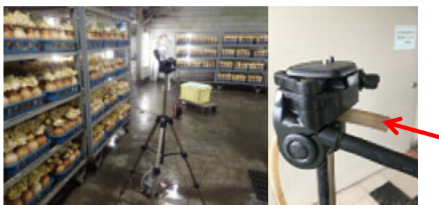
写真2 1万本規模の大量栽培試験の様子 (右写真のエアサンプラーから空気を吸引し、空気中の胞子を含む浮遊物質を測定する)
