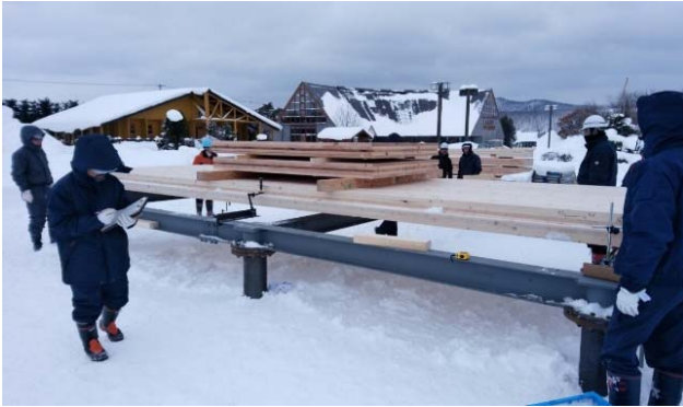
写真5 CLTパネルの曲げ剛性の測定
