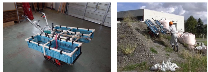
図2 開発した小型の運搬機 傾斜や泥濘に強く，植栽した苗の間を走行でき，コンテナ容器を4つ積むことができる。
