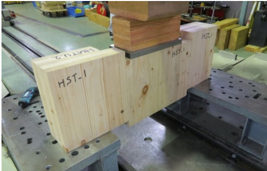
写真2 パネルジョイントのビス接合部せん断実験
