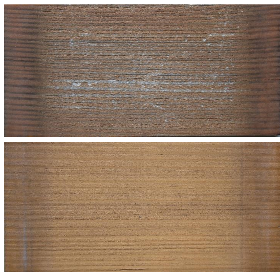
図2 屋外暴露3年経過後の試験体の外観 (上: 塗料1, 下: 塗料2)
