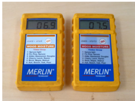
写真2 高周波式木材含水率計 (左：5～8mm用, 右：13～25mm用)
