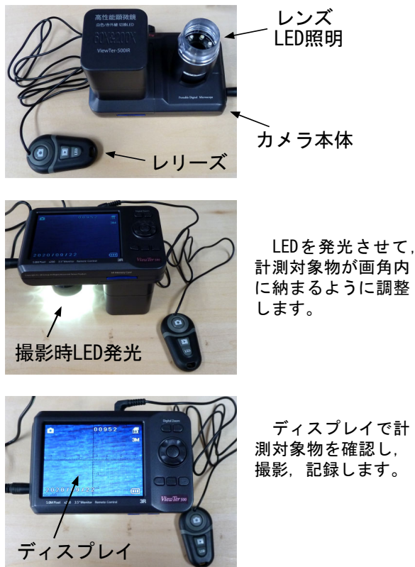
図3 接写式寸法計測用デジタルカメラの概要
