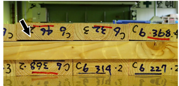
図6 ねじれの大きいラミナを用いたカラマツCLTにおける圧縮前の側面の様子。 (ねじれのため、ラミナ同士が密着せずに隙間がある。)
