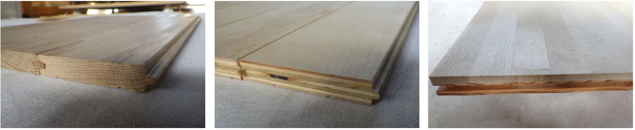
図2 施設床で使用される主なフローリングの例（左：単層フローリング（フローリングボード），中：複合フローリング ボードタイプ，右：複合フローリング 大型積層タイプ）
